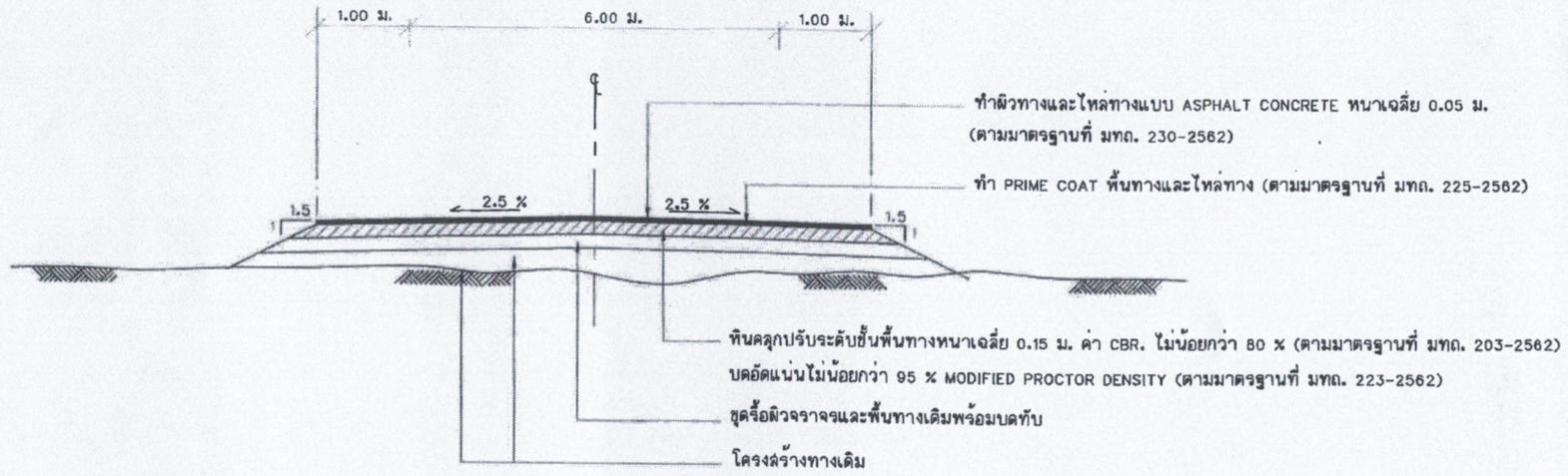
รูปตัด โครงสร้างทางผิวจราจรแบบ ASPHALT CONCRETE (ช่วง กม.2+500 - กม.4+000)
